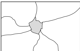
Teilvorgespanntes Glas Bruchbild: Steinwurf
