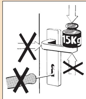
Der Drücker darf nur im normalen Drehsinn belastet werden. In Betätigungsrichtung darf auf den Drücker max. eine Kraft von 150 N aufgebracht werden. Das Schloss bzw. die Mehrfachverriegelung darf nur mit zugehörigem Schlüssel (und nicht mit artfremden Gegenständen) geschlossen werden.
