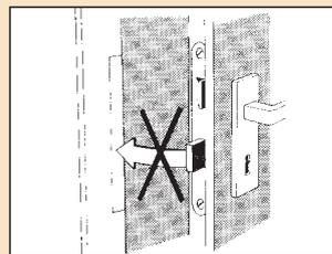
Der Schloss- bzw. Mehrfachverriegelungsriegel darf nicht bei offener Tür vorgeschlossen sein.
