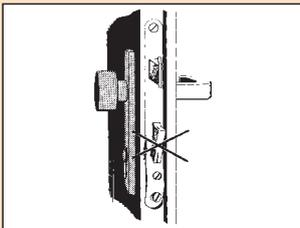
Sobald Spuren von Gewaltanwendung sichtbar sind, muss das Schloss oder die Mehrfachverriegelung ersetzt werden.
