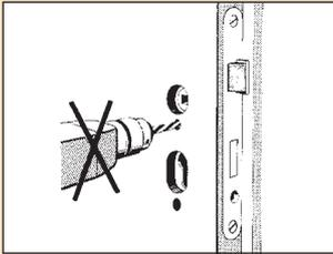
Das Türblatt darf im Schließbereich nicht bei eingebautem Schloss oder eingebauter Mehrfachverriegelung durchbohrt werden.
