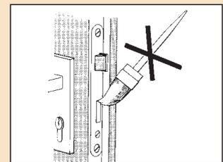
Schlossriegel und -falle bzw. die Verriegelungselemente der Mehrfachverriegelungen dürfen nicht überstrichen oder lackiert werden.
